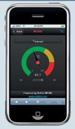
Modbus su seriale RS232/RS485 o LAN TCP/IP, i dispositivi Nethix permettono non solo di visualizzare dal proprio smartphone i dati di funzionamento di qualsiasi impianto, bensì anche di raccoglierli ed elaborarli in grafici e tabelle utili alla valutazione della produttività degli impianti supervisionati.
